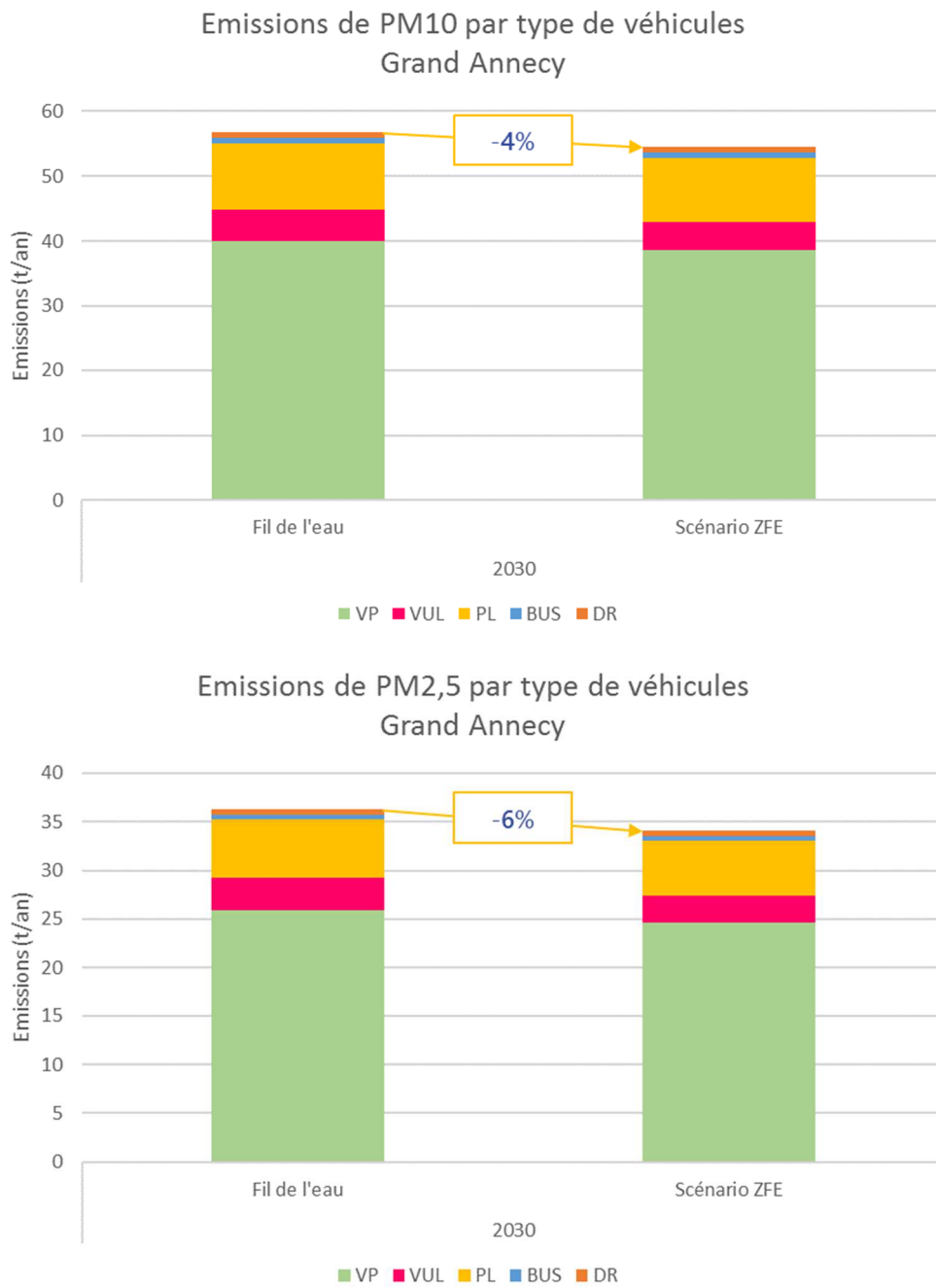
Figure 7 : Emissions de PM10 et PM2,5 calculées en 2030 pour le fil de l'eau et le scénario ZFE-m sur le Grand Annecy
