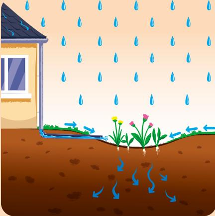
Ce jardin de faible profondeur est conçu pour capter les eaux de gouttières ou de ruissellement et favoriser l'infiltration dans le sol. Les plantes choisies devront supporter la présence intermittente de l'eau.
