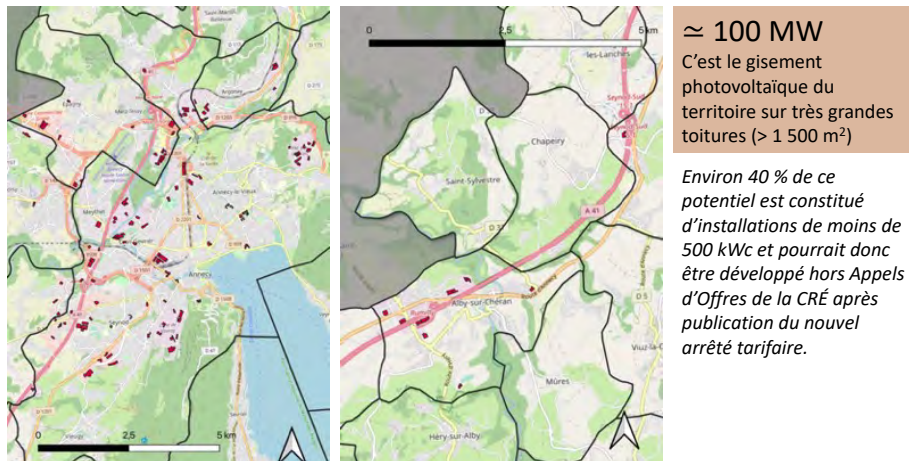
Figure 4 : Prioriser le développement du photovoltaïque sur les grandes toitures du territoire permettrait d'exploiter un potentiel important à partir d'un nombre limité de site.
