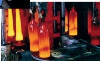
Arrivé à l'usine de recyclage, le calcin est chauffé puis fondu dans des fours à plus de 1500 °C.
